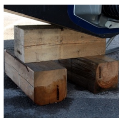
Kjølstøtte motorbåt Min. 4"x 4" trevirke
